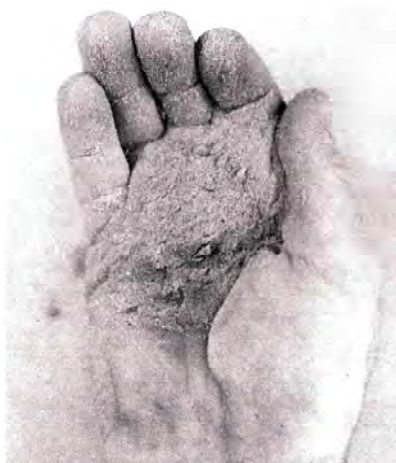
Suelo arenoso. Entre 0 y 25% de humedad. Seca, suelta tiende a fluir entre los dedos.
