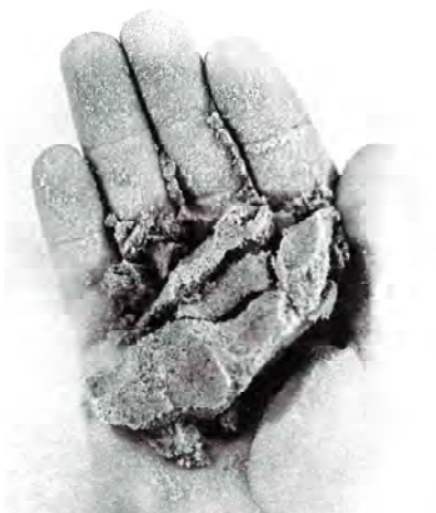
Suelo arenoso. Entre 50 a 75 % de humedad. Bajo presión forma bola poco consistente. No se mantiene unida al soltar la mano.
