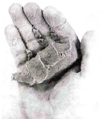
Suelo arenoso. 75 al 100% de humedad. Se forma bola de poca consistencia que se rompe fácilmente y no se puede alisar.
