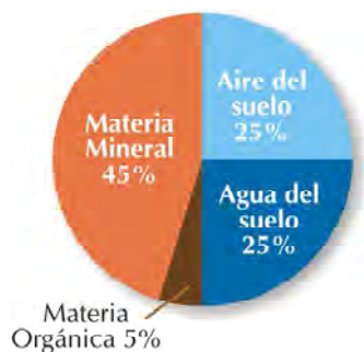
Figura 5. Componentes del suelo. Aproximadamente el 50% del suelo está ocupado por la fase sólida. El otro 50% corresponde a los poros, los que se encuentran ocupados por agua y aire.
