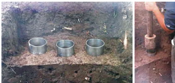
Foto 1. A la izquierda cilindros de volumen conocido para la medición de densidad aparente. A la derecha, barreno de martillo para hincar los cilindros en el suelo.
