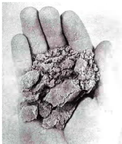
Suelo arenoso. Entre 25 a 50% de humedad. Tiene apariencia seca. No forma bola con la presión.
