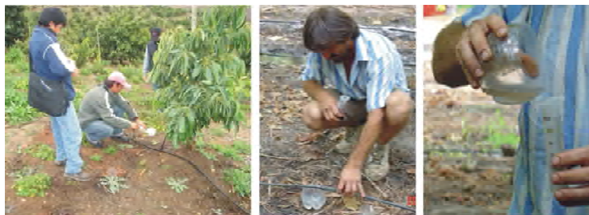
Foto 23. Aforo de goteros y microaspersores.
