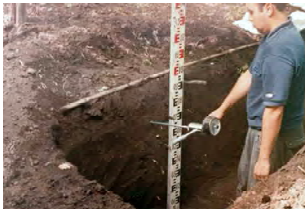
Foto 3. Medición de la resistencia mecánica con penetrómetro.
