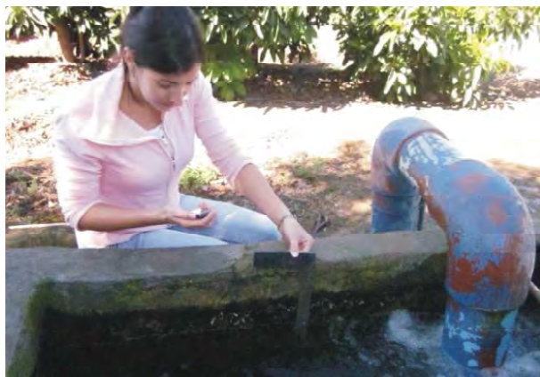
Foto 8. Aforo de pozo que entrega su agua a un estanque donde se puede medir su área con precisión.
