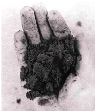
Suelo Franco. Contenido de humedad entre 0 a 25 %. Se desmorona fácilmente pero tiende a compactarse al apretarlo con la mano.
