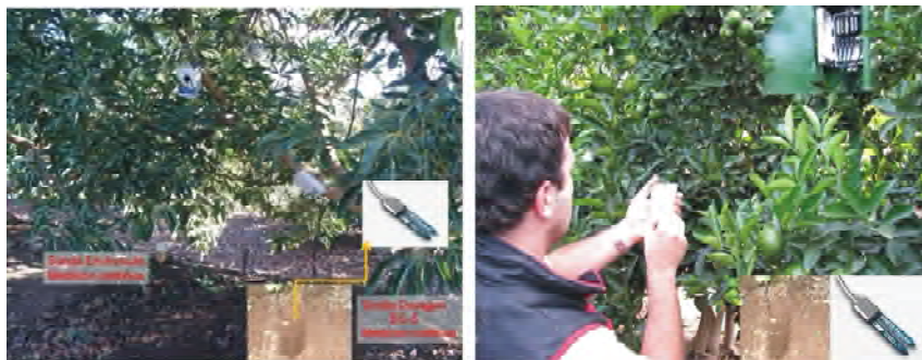
Foto 32. Sensores de humedad basados en sondas capacitivas.
