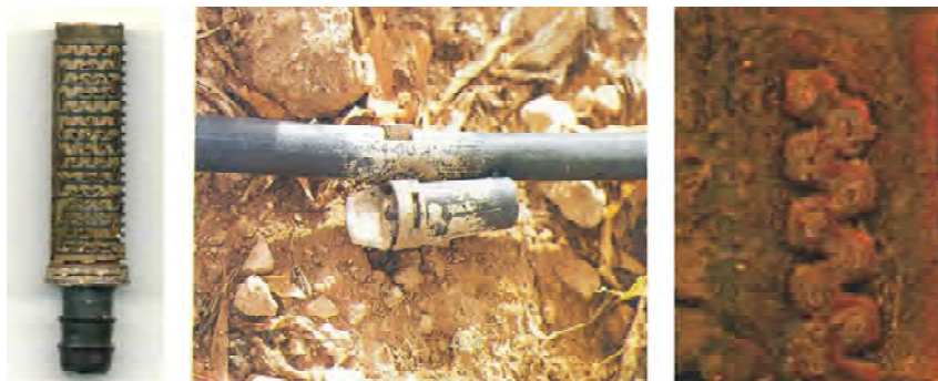
Foto 27. Precipitación de carbonato de calcio y hidróxido férrico
