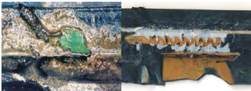
Foto 26. Casos extremos de baba bacteriana unida a limo y arcilla y depósitos de hierro (derecha) y Manganeso (Izquierda).
