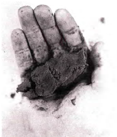
Suelo Franco. 25 al 50% de humedad. Se desmorona algo. Se mantiene consistente con la presión.
