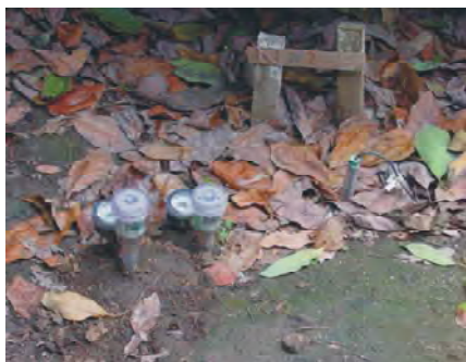
Foto 30. Tensiómetros instalados en palto.
