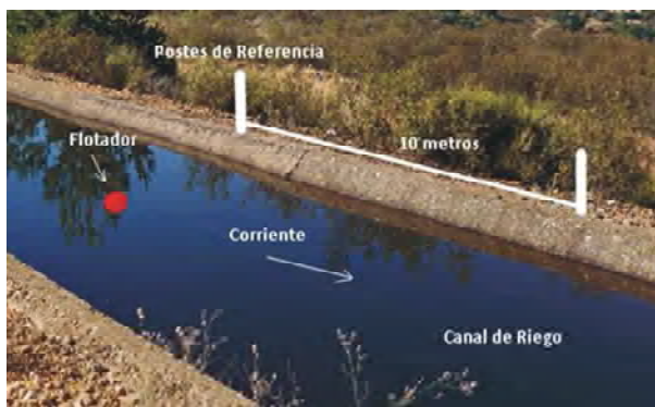
Figura 24. Medición de la velocidad del agua por el método del flotador.
