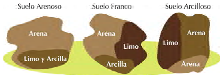
Figura 6. Textura de los suelos: según proporción de arena, limo y arcilla.
