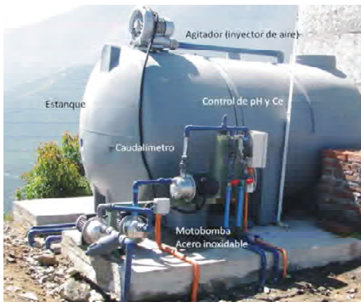
Foto 15. Sistema de inyección de fertilizante con bombas de acero inoxidable y sistema de control de pH y conductividad eléctrica.
