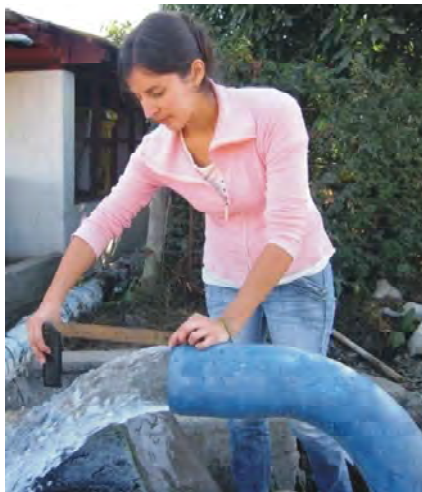
Foto 7. Aforo caudal de un pozo método de la trayectoria.
