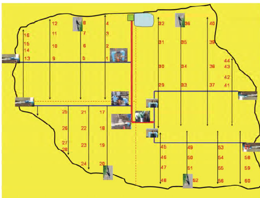
Figura 43. Esquema general de la distribución de emisores a aforar en un equipo de riego localizado para la determinación del CU.
